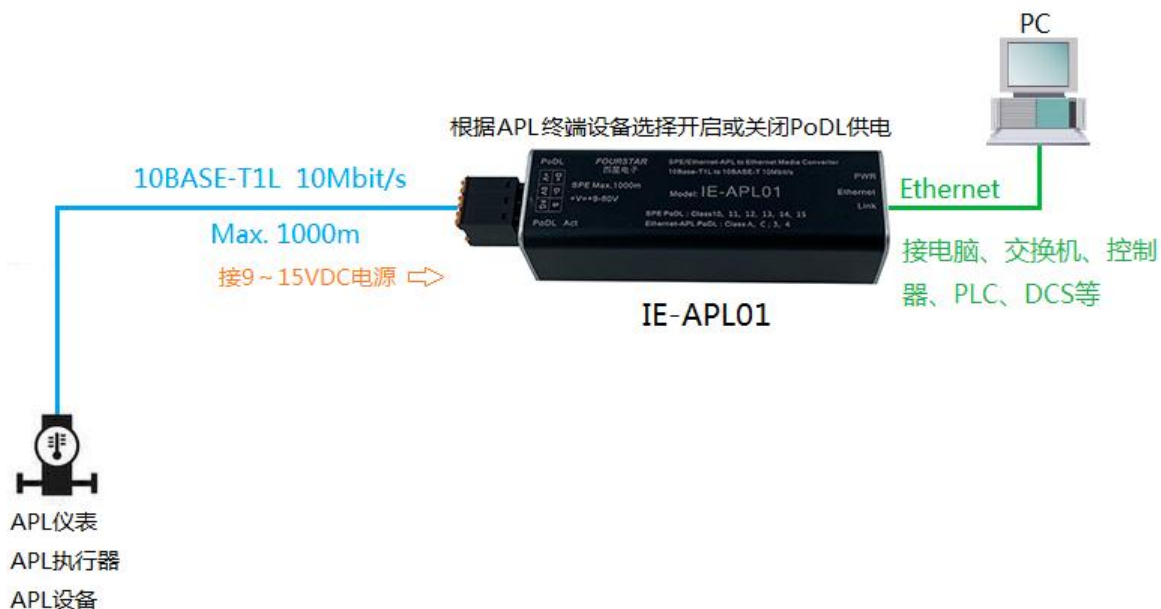
APL到标准以太网介质转换器（相当于单口APL现场交换机）连接拓扑
